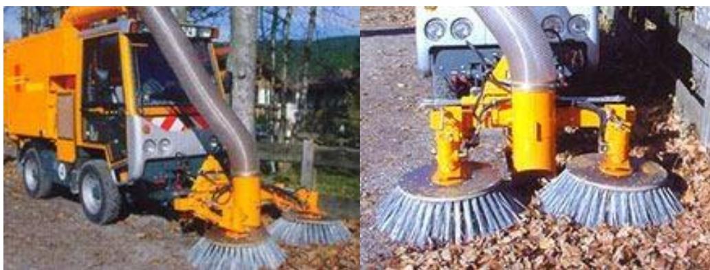
Рисунок 29. Вакуумно-подметальная машина ВОКІ MOBIL для уборки легких материалов (бумага, листья).
